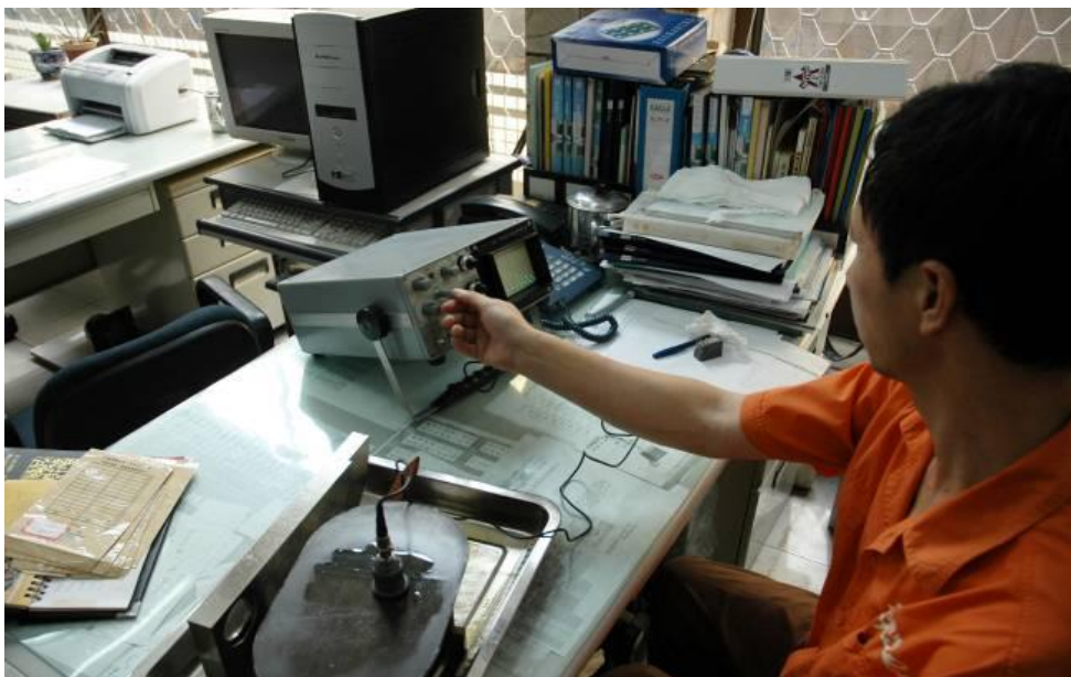
焊接零部件超声波探伤检查
