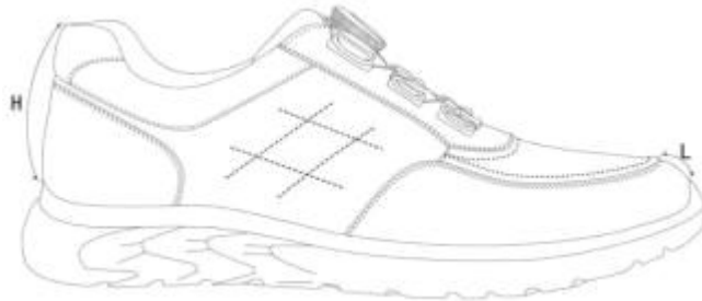
图3 成品尺寸测量部位示意图
