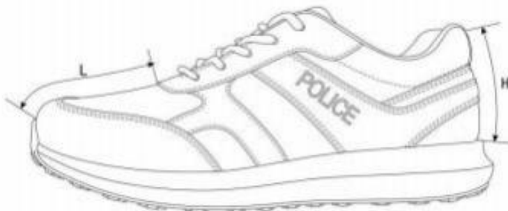
图3 成品尺寸测量部位示意图
