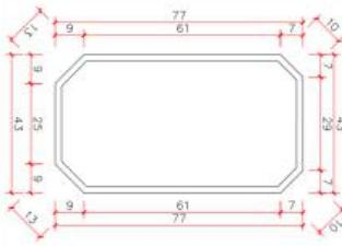
3、床横梁：采用冷轧钢板经成型线轧制而成，立柱成型后尺寸为  $77\text{mm} \times 37\text{mm}$  ( $\pm 2\text{mm}$ )，大侧面单面成型后尺寸为  $\geq 67\text{mm}$ ，中侧面单面成型后尺寸为  $\geq 25\text{mm}$ ，小侧面单面成型后尺寸为  $8\text{mm}$ ，材料厚度为  $\geq 1.5\text{mm}$ 。
