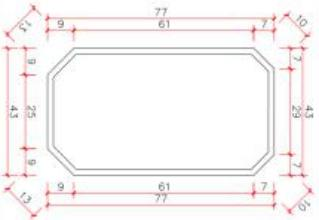
3、床横梁与中床头：采用冷轧钢板经成型线轧制而成，立柱成型后尺寸为 $77\text{mm} \times 37\text{mm}$  ( $\pm 2\text{mm}$ )，大侧面上单面成型后尺寸为 $\geq 67\text{mm}$ ，中侧面上单面成型后尺寸为 $\geq 25\text{mm}$ ，小侧面上单面成型后尺寸为 $\geq 8\text{mm}$ ，材料厚度为 $\geq 1.5\text{mm}$ 。
