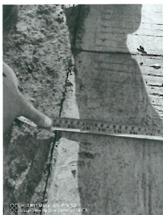
附件 1 (20cm 厚 C25 混凝土路面测量图片)
