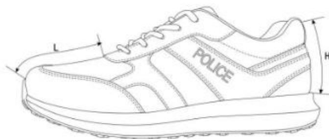
图3 成品尺寸测量部位示意图
