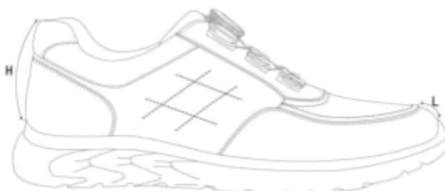
图3 成品尺寸测量部位示意图
