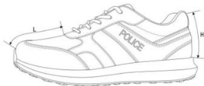
图3 成品尺寸测量部位示意图
