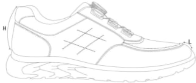
图3 成品尺寸测量部位示意图
