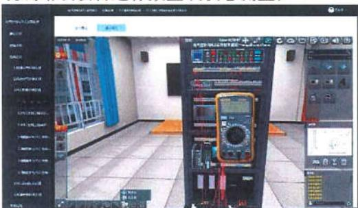
▲8) 学员可以选择不同类型的线材进行系统接线，线材均可以添加、删除、修改、移动、或任意抓取线材的两端接口等；
