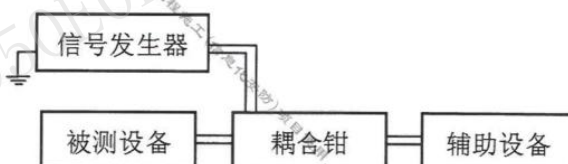
图十八：射频场感应的传导骚扰抗扰度试验被测设备的连接图（网络端口）
