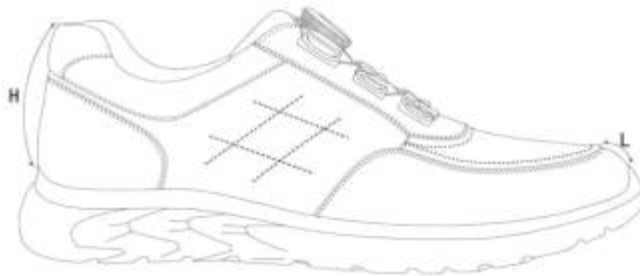
图3 成品尺寸测量部位示意图
